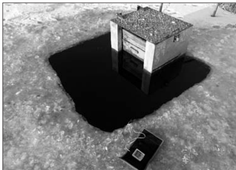
Obsekané výpustné zařízení a následné měření kyslíku a teploty ve vodě
